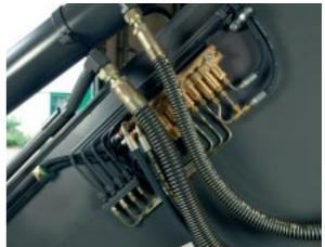
Por motivos de seguridad, el bloque dosificador está montado detrás de las tuberías hidráulicas
